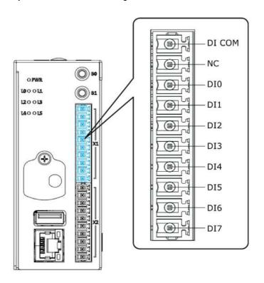
IGT-22 Digital I/O Connector X1 Pin Definition
